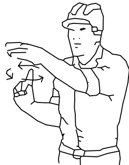
3 Levantar la carga lentamente
