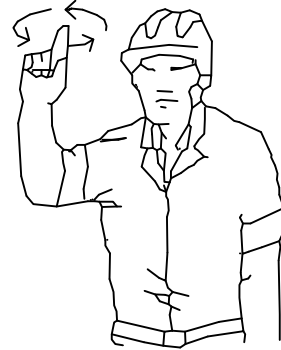
3 Levantar la carga lentamente
