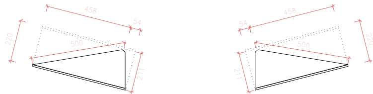
Viga (a): detalle de la cartela (1/2 IPE 220) Viga (b): detalle de la cartela (1/2 IPE 220)
